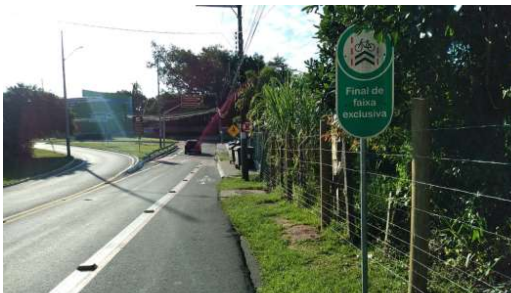
Figura 112 - Sinalização vertical de indicação e sinalização horizontal da ciclofaixa da Avenida Rodesindo Pavan (sentido norte), na chegada à estação laranjeiras.
