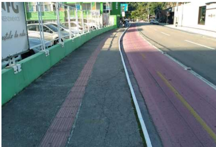
Figura 125 - Calçada com piso podotátil, existente na Avenida Normando Tedesco, defronte ao acesso do estacionamento da estação barra sul.
