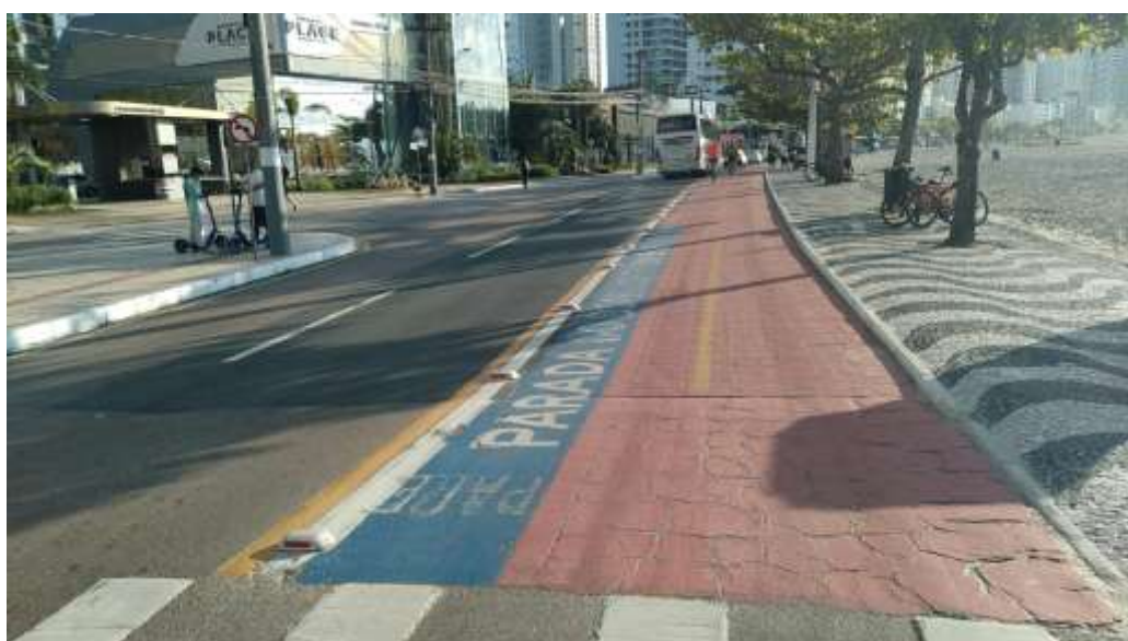
Figura 107 - Parada de ônibus compatibilizada com a ciclofaixa na Avenida Atlântica.
